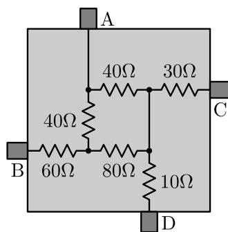
**EXERCICI 2.2** Calculeu la tensió  $V_{AB}$ ,  $V_{DB}$ ,  $V_{CD}$ ,  $V_{AC}$  i  $V_{CB}$  del següent circuit considerant  $R_1 = 0$ ,  $R_2 = 50k\Omega$ ,  $R_3 = 0$ ,  $R_4 = 80k\Omega$ ,  $R_5 = 30k\Omega$ ,  $R_6 = 60k\Omega$ ,  $R_7 = 0$  i  $R_8 = 25k\Omega$ .
