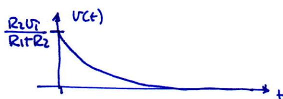
Ex: Circuit per fer un reset automàtic a dispositius utilitzats per digitals, en el moment d'engegar-los.
