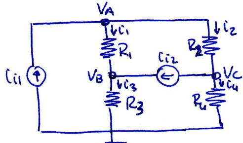
$$\begin{aligned} \text{KCL} \rightarrow i_{ii} - i_1 - i_2 &= 0 & (V_A - V_B)G_1 + (V_A - V_C)G_2 = i_{ii} \\ i_1 + i_{i2} - i_3 &= 0 & -(V_A - V_B)G_1 + V_B G_3 = i_{i2} \\ i_2 - i_{i2} - i_4 &= 0 & -(V_A - V_C)G_2 + V_C G_4 = -i_{i2} \end{aligned}$$
