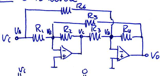
$$-G_1 V_A + (G_1 + G_2 + G_5) V_B - G_2 V_C - G_5 V_D = 0 \quad (G_2 V_C + G_5 V_D = -G_1 V_B)$$
