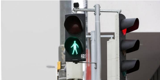
Fig. 6 Sistema semafòric amb sensors per a vianants
