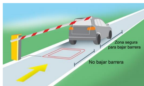
Fig. 1 Exemple de posicionament de detectors de bucle d'inducció
