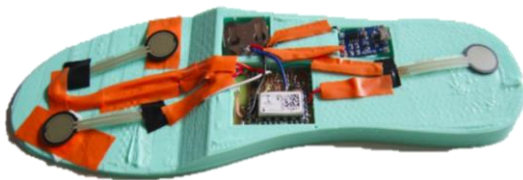
Fig. 1 Plantilla integrada (PCB, sensors, suport). Font: Rofes (2016), pg. 56
