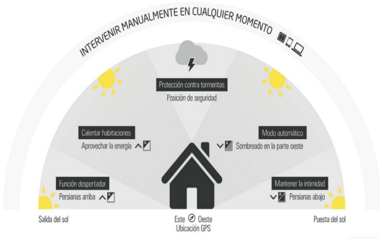
Figura 2. Funcionament de les persianes en una casa intel·ligent.
