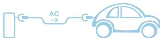
Figura 1: Mode 1, connexió entre el carregador i el vehicle, mitjançant un bus de càrrega amb corrent altern (AC).
