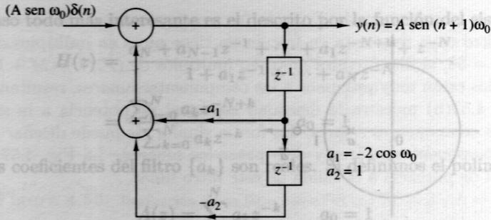
Figura 4.60 Generador digital sinusoidal.
