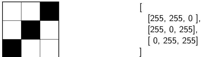
Figura 6: Imatge en blanc i negre de 3 \times 3 píxels (esquerra) i la corresponent matriu de píxels (dreta).
