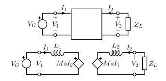
$$\begin{bmatrix} L_1 s & M s \\ M s & L_2 s + Z_L \end{bmatrix} \begin{bmatrix} I_1 \\ I_2 \end{bmatrix} = \begin{bmatrix} V_G \\ 0 \end{bmatrix}$$
