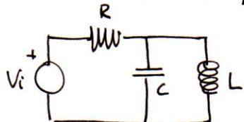
Algunes coses per les podríem deduir sobre el circuit.  $V_o$  val 0 tant per  $\omega=0$  ( $L=\text{c.c.}$ ) com per  $\omega=\infty$  ( $C=\text{c.c.}$ )
