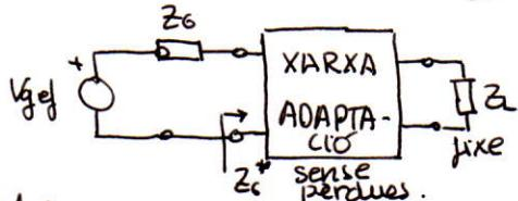
Hauríem de posar un circuit a la capsa que compleixi que tot plegat, capsa + càrrega, tingui una impedància  $Z_0$ .
