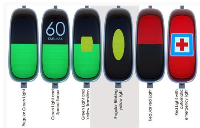
Figura 1: Modes de funcionament del semàfor.
