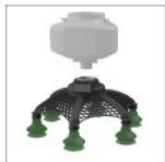
Pinzas fabricadas en 3D
