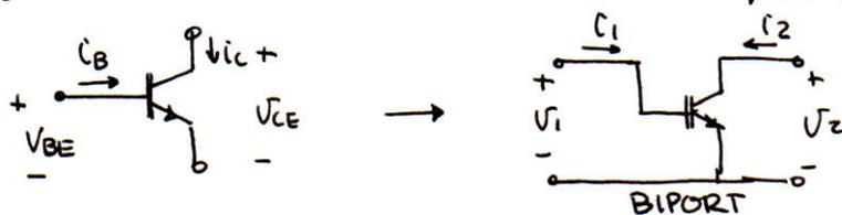
→ Com a element d'acoplament entre una font i una càrrega, com un amplificador:
