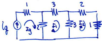
$$\begin{cases} (I_1 - I_2) \cdot 2 + I_1 \cdot 3 + (I_1 - I_2) \cdot 3 = 0 \\ (I_2 - I_1) \cdot 3 + I_2 \cdot 2 + I_2 \cdot 1 = 0 \end{cases} \left\{ \begin{array}{l} \text{Areglant les equacions} \\ \text{i passant els termes} \\ \text{coneguts al segon} \\ \text{membre trobarem:} \end{array} \right.$$
