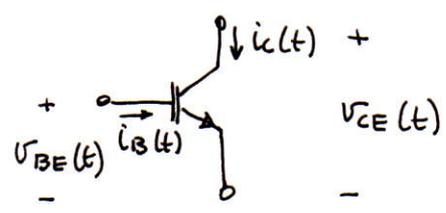
El transistor bipolar té 3 terminals:
