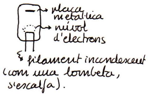
Si tenim una polaritat  $\pm$  (entre placa i filament), tenim una tensió positiva i para corrent. En cas de polaritat inversa, no conduiria. La base del funcionament s'assembla a la d'un díode.
