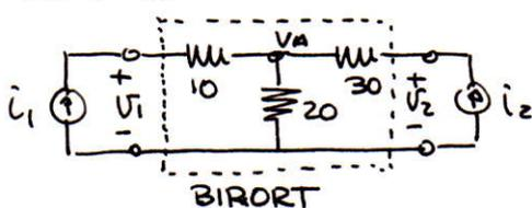
No analitzarem buscant  $v_1$  i  $v_2$  en funció de  $i_1$  i  $i_2$ . Ho podem fer de dues maneres: hem de pensar que, depenent del circuit, serà més útil un mètode o un altre.
