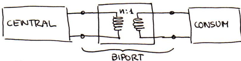
→ Circuits d'adaptació d'impedàncies per aconseguir màxima transferència de potència:
