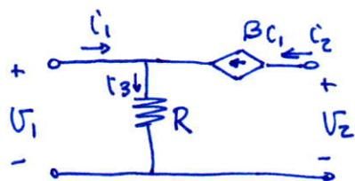
$$\begin{bmatrix} V_1 \\ I_2 \end{bmatrix} = H^1 \begin{bmatrix} I_1 \\ V_2 \end{bmatrix}$$
