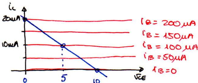
Si  $i_B = 0\mu A$ ,  $i_C = 0mA \Rightarrow V_{CE} = 10V$
