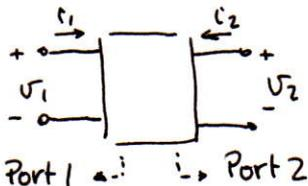
Pot ser un element com el potenciòmetre o el transistor, o un circuit. Es caracteritzaria per dues equacions i 4 variables, dues d'independents i dues de dependents.
