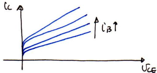
Si ens fixem amb el transistor ideal, veiem que  $i_C$  no depèn de  $V_{CE}$ . La sortida es comportaria com una font de corrent que se governa per la intensitat de base (és a multiplicada aproximadament per 100).
