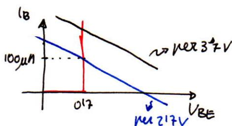
Tenim, en vermell, la corba del transistor i en blau la recta deguda al circuit. Així el circuit treballa a  $100\mu A$  i  $0.7V$ . Si es vol veure què passa per altres  $i_B$ , posaríem una font diferent al circuit, per exemple  $3.7V$  (recta en negra).
